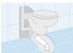
Codo adaptador para instalación de inodoro suspendido con salida a suelo
